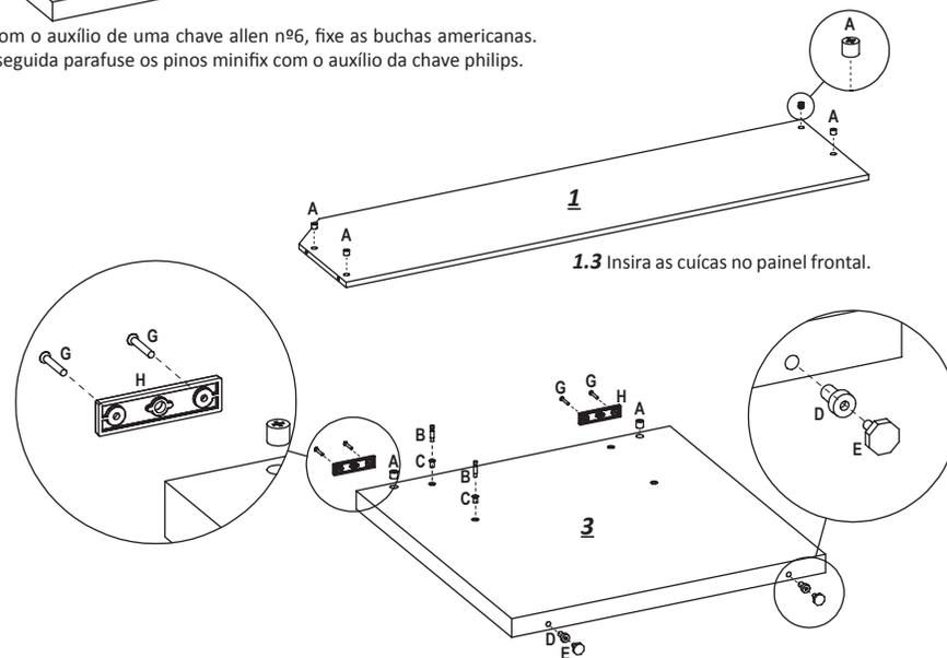
**1.4** Fixe as buchas americanas e parafuse os pinos minifix. Posicione o furo do distanciador com o furo de topo do pé painel e faça a fixação com os parafusos indicados. Por último, com o martelo de borracha, crave a bucha plástica e insira o nivelador.
