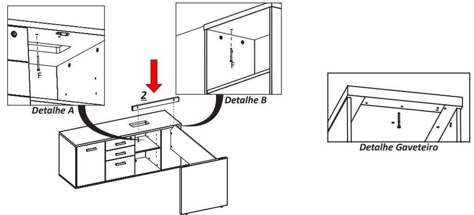
2.3 Faça a fixação do montante no tampo do armário ou Gaveteiro. Na face inferior do tampo existem marcações para fixar o parafuso, conforme Detalhe A e B.
